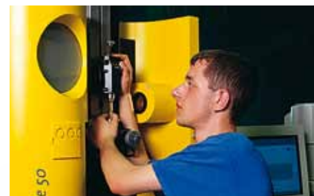
Maßkontrolle im Aufrichtverfahren
