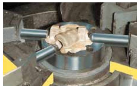
Minimierung des Einsatzgewichtes durch das Hohlpressverfahren
